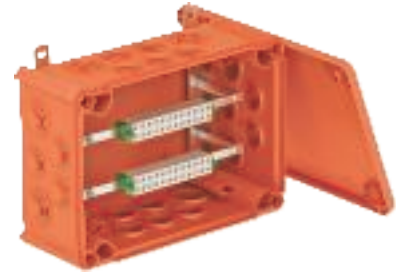
T 350 ED 4-28 AD com fixação exterior com 28 bornes para cabos de dados com fios de 0,8 mm de diâmetro Ref. 7205590
