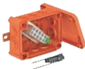
T 100 ED 10-6 AF com fixação exterior com 6 bornes para cabos com secção nominal de 10 mm 2 e suporte de fusível TE-FH 520 Ref. 7205563
