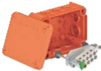
T 100 ED 10-5 com 5 bornes para cabos com secção nominal de 10 mm 2 Ref. 7205533
