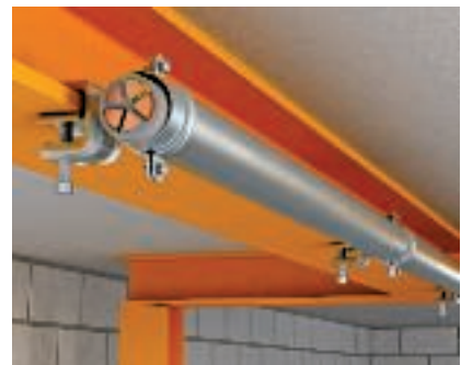
Aplicação de clip, versão para grandes cargas O clip de suspensão pode ser fixado nos sistemas de suporte e vigas de aço. Se necessário, podem ser aplicados no corpo do clip um união roscada dupla (tipo 3100 M8) ou um varão roscado M8. A figura mostra uma ligação com abraçadeira para cabos e tubos.
