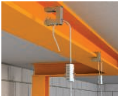
Aplicação de cabo metálico A abertura vertical (parte de trás 8x9,5 mm) do clip de suspensão, permite aplicações com cabo metálico.
