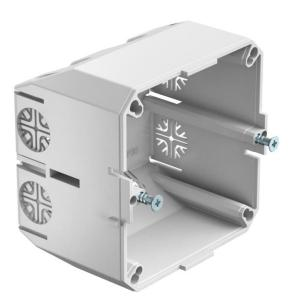
Caixa de aparelhagem para montagem de aparelhos com espelhos em calhas de instalação WDK com altura da calha de 60 mm. A caixa de aparelhagem é encaixada nas paredes da calha e fixada com um parafuso no centro.
