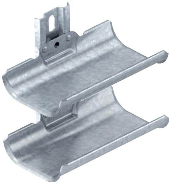
Porta-cabos para uma colocação de cabos simples e rápida em áreas de aplicação em que não possam ser montados sistemas de caminhos de cabos convencionais. Os porta-cabos possuem uma grande superfície de contacto e arestas exteriores arredondadas para a proteção dos cabos. Com base na norma VIN DVE 0298-300, não deve ser excedida a distância de apoio de 0,8 m.
