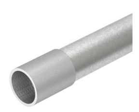
Tubo de instalação elétrica conforme EN 61386-1, com pontas roscadas conforme DIN EN 60423, para a proteção mecânica de cabos e condutores. Com parede interior sem rebarbas. Classe de proteção contra corrosão 4 (elevada). Cada tubo já inclui uma união instalada.
