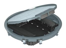
Tampa de encastramento GESR9 com uma altura de instalação fixa de 55 mm em interiores. Com dois suportes de aparelhos para montagem vertical de aparelhos Modul 45 e quatro fixadores para alívio de tensão. Para a montagem de aparelhagem Modul 45 são necessárias dois suportes de aparelhos.
