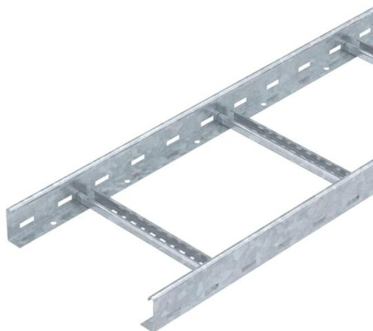
Caminho de cabos tipo escada com aba perforada de 60 mm com degraus em perfil C, rebitados e abertos para cima (versão VS).
