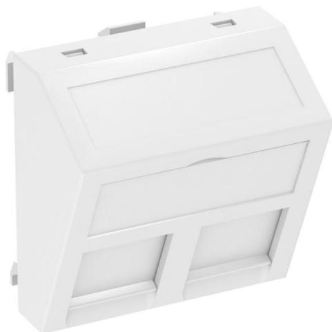
Espelho para conectores de dados com saída inclinada e fecho de correção para alojamento de dois conectores RJ45. A saída tem uma tampa deslizante de bloqueio, adequada tanto para a instalação vertical como horizontal. O Tipo C tem uma abertura de montagem de 19,30 x 14,80 mm e foi concebido para a fixação direta de conectores de dados.
