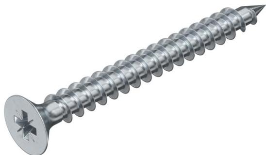
Aço temperado, galvanizado a zinco e revestido a Hostaflon. Cabeça de embeber com parafuso Philips (Pozidrive tamanho 2, exceto Ø 6 mm Pozidrive tamanho 3).
