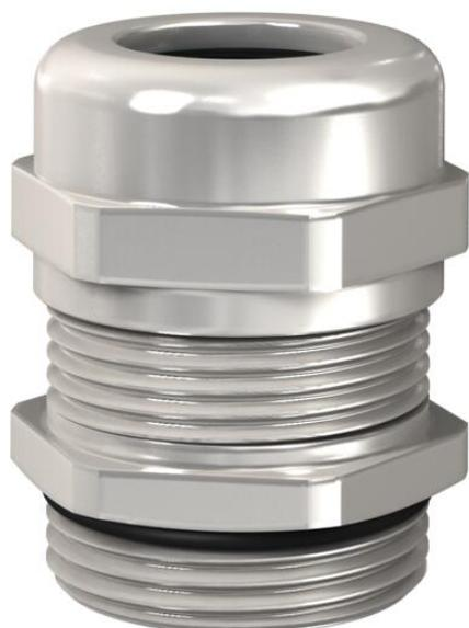
Bucim testado para CEM, com rosca métrica conforme a IEC 423, este robusto bucim tem elevados requisitos em termos de impermeabilidade. O contacto entre o bucim e a superfície de blindagem é efetuado através de uma mola de contacto. Alívio de tensão, proteção contra aperto e torção em toda a área de fixação. Anel de vedação em neopreno. Elemento de aperto em poliamida. Com anel de vedação O pré-montado na rosca, testado pela VDE conforme DIN EN 50262, tipo de c IP68 com 5 bar/1 h.
