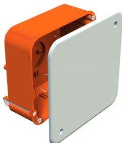
Caixa de derivação para utilização em paredes ocas com uma profundidade de instalação de pelo menos 50 mm e uma espessura de placa de 7 - 35 mm. Com tampa branca e parafusos na tampa. Adequada para a montagem de calhas normalizadas (calhas de cobertura e de suporte) para bornes em série.
