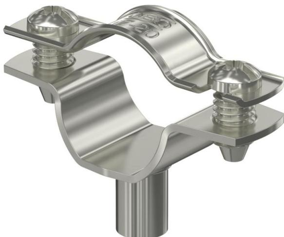
Abraçadeira distanciadora para montagem de tubos e cabos na parede, teto e chão. Com tampa de travamento automático. Fixação através de aplicação com rosca fêmea. Superfícies G e FT, a partir do tamanho 20 da abraçadeira, adequadas para montagem com pistola de pregos ou pistola para pinos.
