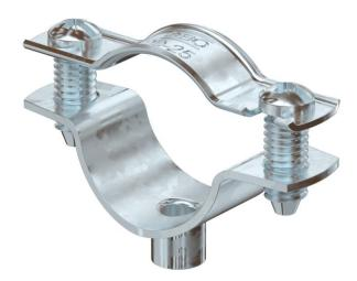
Abraçadeira distanciadora para montagem de tubos e cabos na parede, teto e chão. Com tampa de travamento automático. Fixação através de aplicação com rosca fêmea. Superfícies G e FT, a partir do tamanho 20 da abraçadeira, adequadas para montagem com pistola de pregos ou pistola para pinos.
