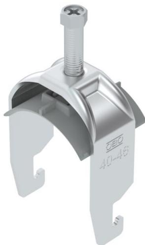
Abraçadeira BBS tipo U, placa de pressão em plástico de polipropileno. Para montagem vertical e horizontal de 1 cabo individual em perfil C. Para largura de rasgo 18 - 22 mm. Com parafuso simples na placa de pressão, cabeça de parafuso hexagonal universal tam. 10, com fenda e fenda em cruz. Adequado para montagem em áreas interiores e exteriores. Recomenda-se o uso de uma contraplaca.
