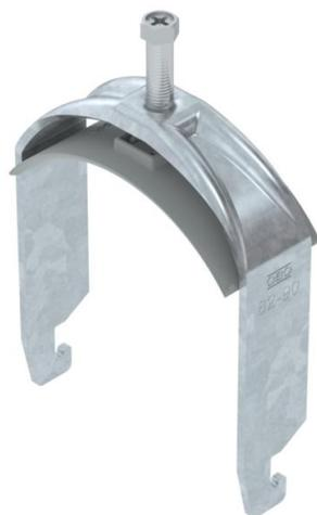
Abraçadeira BBS tipo U, placa de pressão em plástico de polipropileno. Para montagem vertical e horizontal de 1 cabo individual em perfil C. Para largura de rasgo 18 - 22 mm. Com parafuso simples na placa de pressão, cabeça de parafuso hexagonal universal tam. 10, com fenda e fenda em cruz. Adequado para montagem em áreas interiores e exteriores. Recomenda-se o uso de uma contraplaca.
