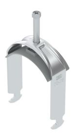
Abraçadeira BBS tipo cabeça de martelo, placa de pressão em plástico de polipropileno. Para montagem vertical e horizontal de 1 cabo individual em perfil C. Para largura de rasgo 16 - 17 mm. Com parafuso simples na placa de pressão, cabeça de parafuso hexagonal universal tam. 10, com fenda e fenda em cruz. Adequado para montagem em áreas interiores e exteriores. Recomenda-se o uso de uma contraplaca.
