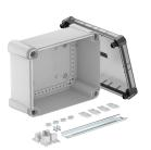
Caixa de derivação com calha DIN para conectar cabos e tubos em áreas interiores e exteriores. Forma retangular sem entradas. Adequado para montagem na parede e teto com opção para fixação externa ou montagem através de parafusos nos cantos. Particularmente resistente ao impacto com IK09. Tampa transparente com fecho rápido, pode ser selada a chumbo. Fabricada em materiais resistentes aos raios UV e livres de halogéneo.
