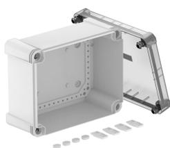
Caixa de derivação para conectar cabos e tubos em áreas interiores e exteriores. Forma retangular sem entradas. Adequado para montagem na parede e teto com opção para fixação externa ou montagem através de parafusos nos cantos. Particularmente resistente ao impacto com IK09. Tampa transparente com fecho rápido, pode ser selada a chumbo. Fabricada em materiais resistentes aos raios UV e livres de halogéneo.
