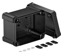
Caixa de derivação para conectar cabos e tubos em áreas interiores e exteriores. Forma retangular sem entradas. Adequado para montagem na parede e teto com opção para fixação externa ou montagem através de parafusos nos cantos. Particularmente resistente ao impacto com IK09. Tampa com fecho rápido, pode ser selada a chumbo. Fabricado em materiais livres halogéneo e resistentes ao UV.
