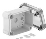
Caixa de derivação para conectar cabos e tubos em áreas interiores e exteriores. Forma retangular sem entradas. Adequado para montagem na parede e teto com opção para fixação externa ou montagem através de parafusos nos cantos. Particularmente resistente ao impacto com IK08. Tampa transparente com fecho rápido, pode ser selada a chumbo. Fabricado em materiais livres halogéneo e resistentes ao UV.
