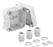
Caixa de derivação para conectar cabos e tubos em áreas interiores e exteriores. Forma quadrada com entradas quebráveis. Adequado para montagem na parede e teto com opção para fixação externa ou montagem através de parafusos nos cantos. Particularmente resistente ao impacto com IK09. Tampa com fecho rápido, pode ser selada a chumbo. Fabricada em materiais resistentes aos raios UV e livres de halogéneo.
