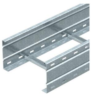
Caminhos de cabos tipo escada para grandes vãos com aba perfurada de 160 mm. Fixação de cabos e condutas com abraçadeira BSS tipo 2056. As uniões WRV 160 devem ser encomendadas separadamente. Atenuação da blindagem magnética sem tampa 10 dB, com tampa 15 dB.
