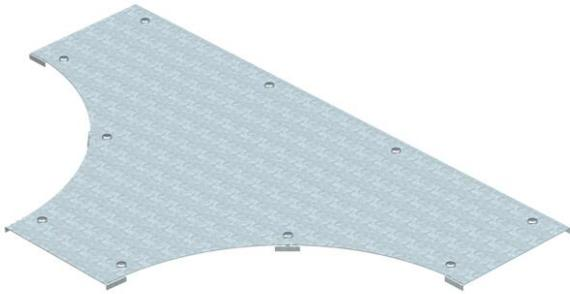
Tampa para derivação T de grandes vãos, com ferrolhos pré-montados. Devido ao ferrolho montado por fora, a tampa do acessório é 300 mm mais curta do que o respetivo acessório. Isto deve ser tido em consideração durante a instalação do elemento.
