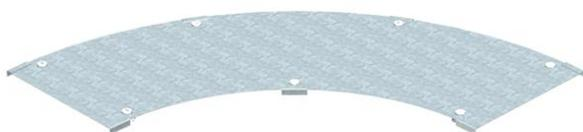
Tampa para ângulos de 90° de grandes cargas com ferrolhos pré-montados. Devido ao ferrolho montado por fora, a tampa do acessório é 300 mm mais curta do que o respetivo acessório. Isto deve ser tido em consideração durante a instalação do elemento.
