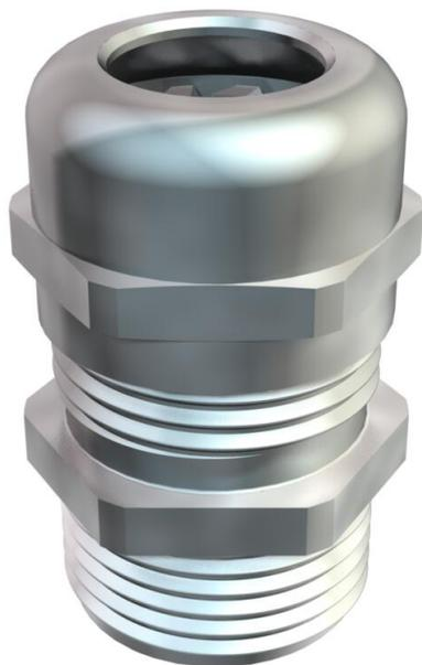
Para uma elevada capacidade de vedação são exigidos bucins robustos com grande capacidade de vedação, assim como alívio de tensão e proteção contra torção, com rosca PG longa conforme DIN 40430, para instalação em paredes mais espessas em conjunto com porcas.
