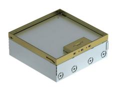
Caixa de pavimento quadrada para utilização em chão falso de limpeza a seco e betonilha em áreas interiores. Caixa com aberturas de entrada para tubos (M25). Tampa ajustável ao rebordo superior do revestimento do pavimento, através de 4 apoios de nivelamento. A profundidade mínima de montagem é de 95 mm, a amplitude de nivelamento + 30 mm.
