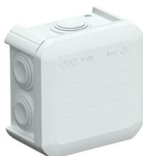
Caixa de derivação para conectar cabos em áreas interiores e áreas exteriores protegidas. Forma quadrada com buçins cónicos nas laterais e entradas quebráveis na base. Adequado para a montagem na parede / teto e para a montagem em suportes para caixas de derivação. Com opção de fixação interna. Com tampa de aperto fixa. Fabricado em materiais resistentes aos raios UV e livres de halogéneo.
