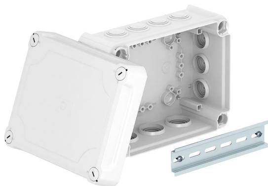
Caixa de derivação para conectar cabos em áreas interiores e áreas exteriores protegidas. Forma retangular com buçins cónicos nas laterais e entradas quebráveis na base. Adequado para a montagem na parede / teto e para a montagem em suportes para caixas de derivação. Com opção de fixação interna e montagem através de parafusos nos cantos. Tampa alta com fecho rápido, pode ser selada a chumbo. Fabricada em materiais resistentes aos raios UV e livres de halogéneo.
