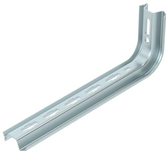
Perfil TP com comprimento de 145 - 645 mm, para utilização como perfil - cargas ligeiras em tectos de betão horizontais. Até um comprimento de 345 mm, o perfil também é utilizado como consola para parede e para pendural. Se o perfil for fixado no tecto ou se for aparafusado para reforço superior, por motivos de estabilidade, deve ser sempre utilizado o acessório de aperto do tipo DS 4.
