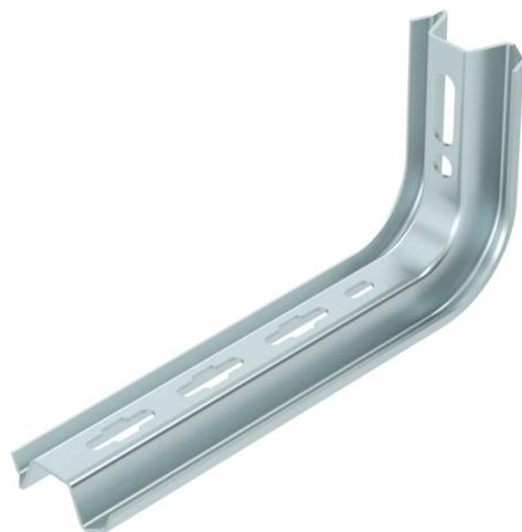
Perfil TP com comprimento de 145 - 645 mm, para utilização como perfil - cargas ligeiras em tectos de betão horizontais. Até um comprimento de 345 mm, o perfil também é utilizado como consola para parede e para pendural. Se o perfil for fixado no tecto ou se for aparafusado para reforço superior, por motivos de estabilidade, deve ser sempre utilizado o acessório de aperto do tipo DS 4.
