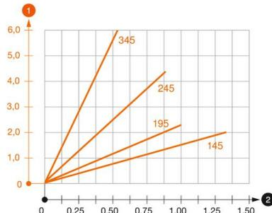
Diagrama de cargas da consola TPSAG de encaixe rápido
