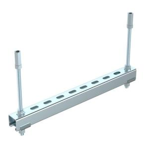
Material de suspensão e fixação em aço para a realização do primeiro suporte de instalações em selagens antifogo. Montagem do pêndulo com varões roscados sob o teto. No máximo podem ser montadas duas camadas com uniões de dois conjuntos. As construções de apoio devem ser montadas em ambos os lados da parede à distância prescrita do sistema de selagem. Inclui 2 x MMS-plus I 7,5x40
