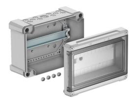
Quadro de distribuição para montagem à superfície, para sub-distribuição de energia em área interior e área exterior protegida, de acordo com a IEC 439-3. Com calha DIN de 35 mm pré-montada. Tipo de proteção IP66 e grau de proteção IK06. Tampa transparente para aparafusar, com recorte.
