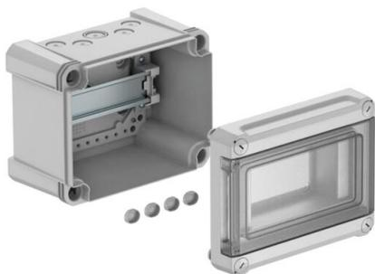
Quadro de distribuição com régua de bornes para montagem à superfície, para sub-distribuição de energia em área interior e exterior, de acordo com a IEC 439-3. Com calha DIN de 35 mm pré-montada. Tipo de proteção IP66 e grau de proteção IK06. Tampa transparente para aparafusar, com recorte. Inclui 4 tampas de cobertura dos parafusos.
