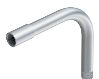
Ângulo de 90° para tubos de instalação elétrica conforme a EN 61386-1 com pontas roscadas de acordo com DIN EN 60423. Parede interior sem rebarbas. Cada ângulo de tubo já inclui uma união instalada.
