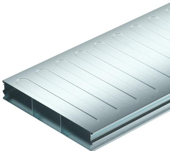
Calha de pavimento (2 peças) para colocação dos cabos e linhas em sistemas de pavimentos cobertos de betonilha, de acordo com a norma EN 50085-2-2. Tampa de fundo e tampa da calha contínua. Com separador na base da calha. Compatível apenas com o UZD250-4/350-4. As paredes laterais perfiladas proporcionam uma função de encaixe para encaixar a tampa da calha na base. O reforço das esferas na tampa da calha servem para a estabilização.
