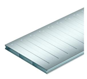
Calha de pavimento (2 peças) para colocação dos cabos e linhas em sistemas de pavimentos cobertos de betonilha, de acordo com a norma EN 50085-2-2. Tampa de fundo e tampa da calha contínua. Com separador na base da calha. As paredes laterais perfiladas proporcionam uma função de encaixe para encaixar a tampa da calha na base. O reforço das esferas na tampa da calha servem para a estabilização.
