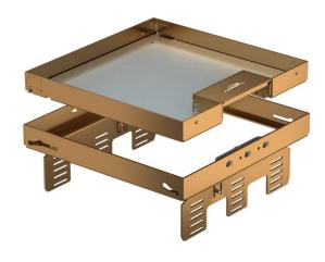
Tampa nivelável e desacoplada do pavimento de tamanho nominal 9, com saída de cabos, para a montagem de aparelhos de instalação em pavimentos tratados a seco em interiores, para montagem em caixas de pavimento UZD250-3 ou UZD350-3, em cada caso em conjunto com um aro de redução DUG../9 ou em UGD250-3/9 ou UGD350-3/9. A montagem é efetuada através de niveladores (encomendar separadamente) no perfil da estrutura de alumínio das caixas de pavimento.
