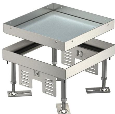
Tampa quadrada "cega" para grandes cargas no tamanho nominal 4 para a criação de uma abertura de inspeção em sistemas de calhas de pavimento, chãos falsos, em pavimentos tratados a seco ou a húmido em interiores. Classe de carga 1 a 10 kN. Apenas adequada para pavimentos lisos.
