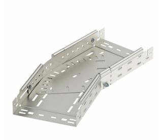
Ângulo variável de 0° - 90° com união de encaixe rápido. Para todos os tipos de caminhos de cabos em chapa com a altura lateral de 60 mm.
