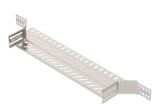
Derivação simples para a criação de um ramal ou cruzeta horizontal, para caminhos de cabos em chapa de encaixe e de aparafusar, altura lateral de 60 mm. Montagem sem parafusos com grampos duplos ou ligação roscada com parafusos de cabeça boleada FRS e porcas combinadas M6. Indicado para áreas interiores e exteriores. O material de fixação terá que ser encomendado em separado.
