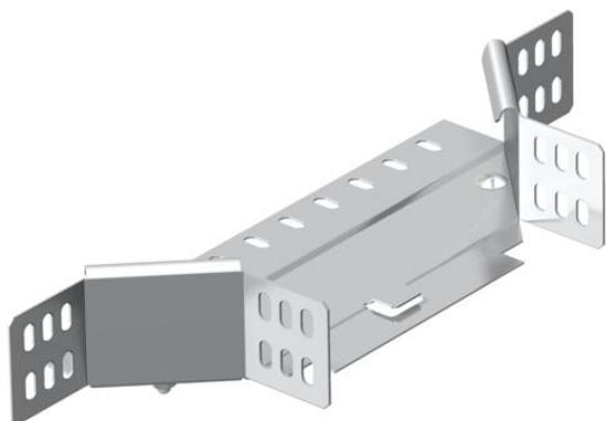
Derivação simples para montagem horizontal e vertical. Para todos os tipos de caminhos de cabos em chapa com altura lateral de 60 mm. O acessório é fornecido desmontado. Inclui o respectivo material de fixação.
