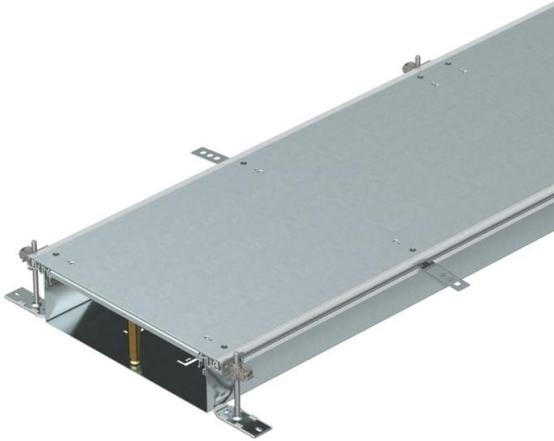
Calha para a condução de cabos, com 3 tampas com mola, constituída por base e laterais em chapa. Base inferior do pavimento com entalhes para a montagem por encaixe dos separadores. O material fornecido inclui 6 esquadros de fixação com nivelamento de altura, 6 escoras estabilizadoras 6 escoras estabilizadoras e tampas 3 unid. em calhas de 200, 300 e de 400 e 6 unid. em calhas de 500 e 600. Calha fornecida com a tampa de mola montada
