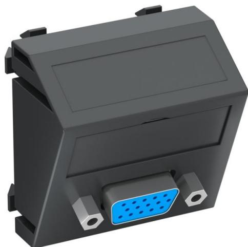
Suporte de multimédia com uma tomada de ligação VGA, saída de cabo inclinada, com campo de inscrição, tomada VGA (HD15) com conexão de rosca. Espelho com fixação por encaixe, adequado para a montagem horizontal e vertical em todo o sistema.
