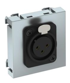
Suporte de multimédia com uma tomada de ligação XLR, saída de cabo plana, sem campo de inscrição, tomada XLR de 3 polos, com ligação roscada. Espelho com fixação por encaixe, adequado para a montagem horizontal e vertical em todo o sistema.
