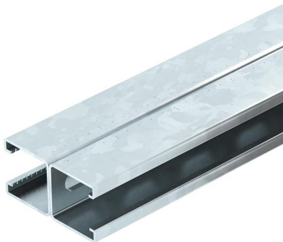
Perfil de montagem perfurado na base, para grandes cargas, e uma largura de rasgo de 22 mm. Na versão dupla, isto é com dois perfis interligados no pavimento (rebitados).
