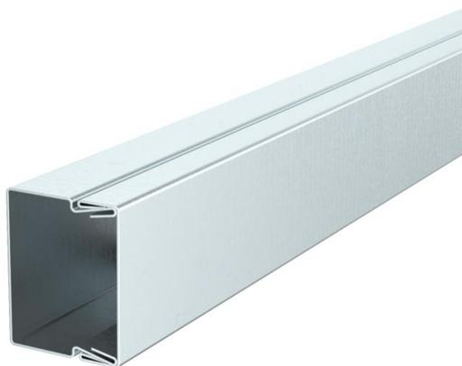
Tampa e base da calha com perfuração. A ligação equipotencial entre a tampa e a base está garantida sem outros meios auxiliares. A calha do tipo LKM 20030 está testada como sistema de instalação para manutenção de funções conforme a DIN 4102 parte 12. Tenha em consideração os tipos de cabos na utilização como sistemas antifogo BSS!
