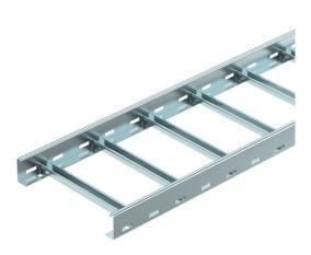
Escada para a colocação vertical de cabos e condutores. Aplicável como estrutura de suporte normalizada para a manutenção de funções conforme a DIN 4102 parte 12 Classes de manutenção de funções E30 até E90. Com degrau em perfil C rebitado com abertura para cima.
