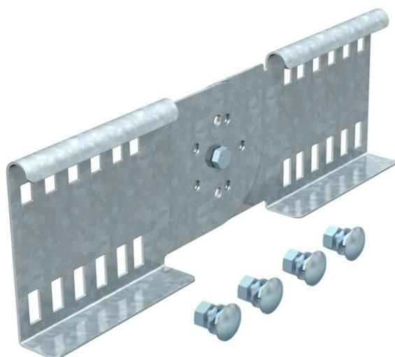
União articulada para a ligação de caminhos de cabos tipo escada com aba de 110 mm e perfuração contínua. Ângulo ajustável verticalmente. A consistência da equipotencialização é garantida com recurso a acessórios de conexão.
