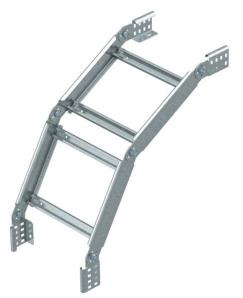
Ângulo vertical regulável de 90°, para caminhos de cabos tipo escada com degraus VS e altura lateral de 60 mm. O acessório é fornecido desmontado, incluindo uniões articuladas e os respecti-
